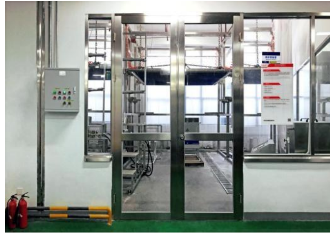
Камера для испытаний на водонепроницаемость
